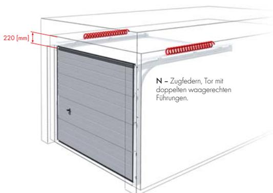
N - Zugfedern, Tor mit doppelten waagerechten Führungen.
