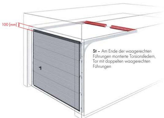
**Sf** – Am Ende der waagerechten Führungen montierte Torsionsfedern, Tor mit doppelten waagerechten Führungen
