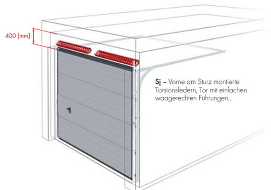
Sj - Vorne am Sturz montierte Torsionsfedern, Tor mit einfachen waagerechten Führungen..
