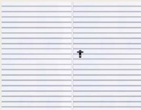
Zweiflügeliges Tor gefüllt mit T-10 Trapezblech, waagerechte Anordnung der Torfüllung
