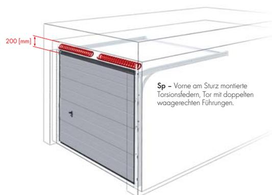
**Sp** – Vorne am Sturz montierte Torsionsfedern, Tor mit doppelten waagerechten Führungen.
