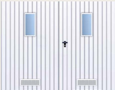
Zweiflügeliges Tor gefüllt mit T-10 Trapezblech, senkrechte Anordnung der Torfüllung, Tor mit Fenstereinsätzen in senkrechter Anordnung und mit Belüftungsgitter
