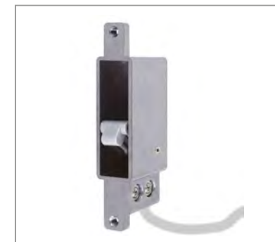
RIEGELKONTAKT Im Schließblech eingebaut. Wird durch den Riegel im Schloss betätigt. Rückmeldung: Tür manuel oder mechanisch abgeschlossen!
